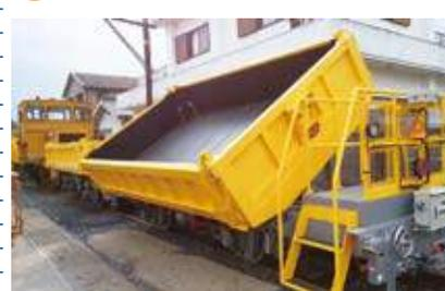
貴志川線に新車両が入線しました。と言っても工事などに使われる保線用車両ですが、線路に敷く砂利などを運ぶ車両で、今回新たに3両が新車が入線しました。これまでの車両と比べると保線員が操作するためのデッキが新設され、ライトもLED化、そして積み荷の砂利を線路に撒けるようにダンブトラックのように荷台が傾斜するのが大きな特徴で、左右横だけでなく縦にも傾斜するのが大きな特徴です。1月20日から使用開始になっているようです。安全運航のための新戦力です。
